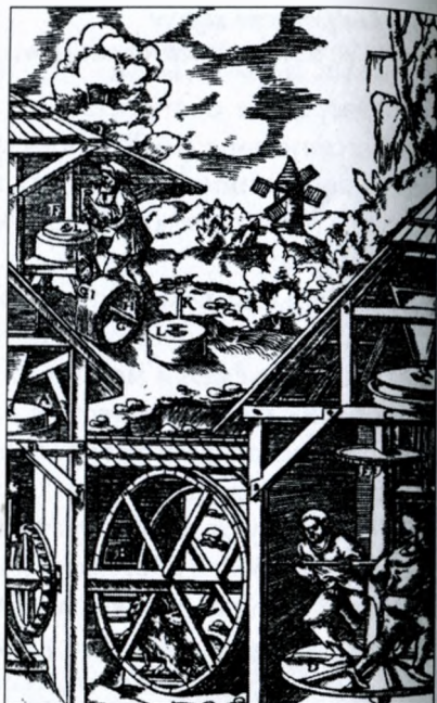
Ступенчатые вертикальное и горизонтальные колеса (топчаки) в мельнице (Agrikola_1556-315.jpg)
