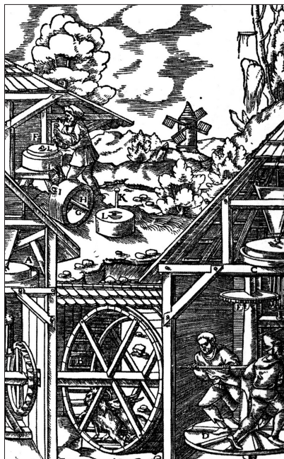
Ступенчатые вертикальное и горизонтальные колеса (топчак) в мельнице (Agrikola_1556-315.jpg)
