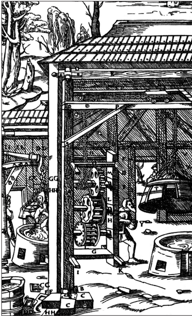
Ворот крана для подвѣма колтака печи (Agrikola_1556-463.jpg)
